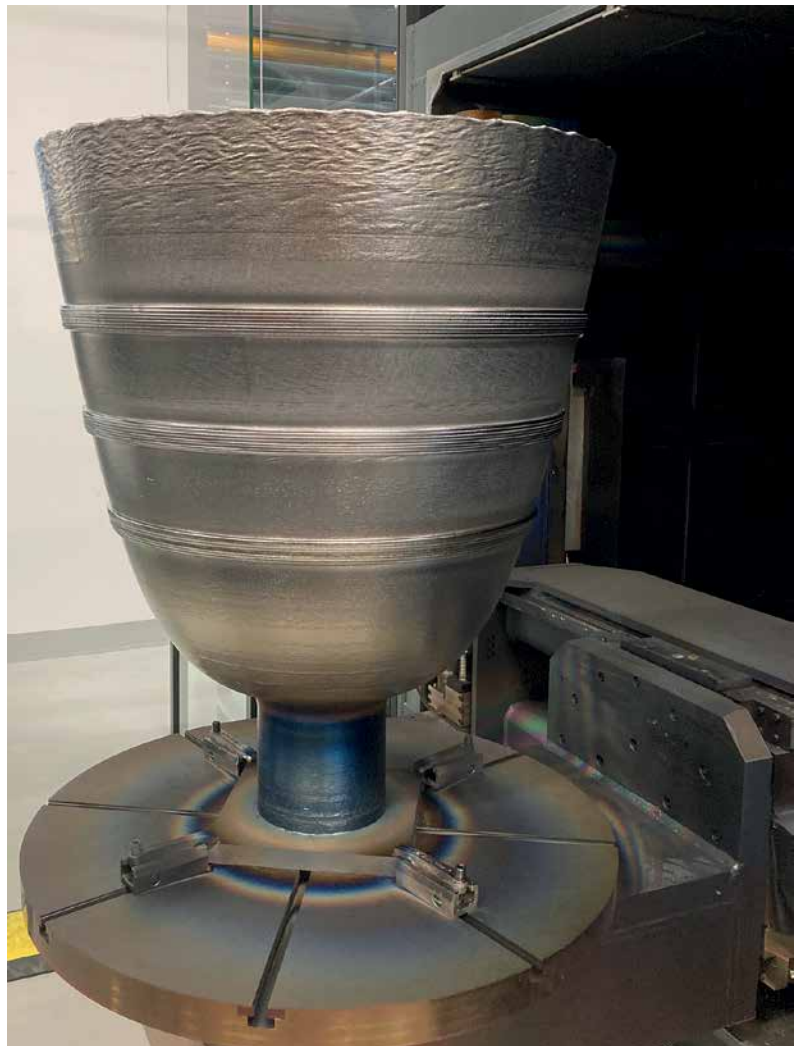
Modell einer Raketenantriebsdüse aus Ti6Al4V mit Versteifungsringen (Höhe 1 m, Gewicht 53 kg). PRO-BEAM
