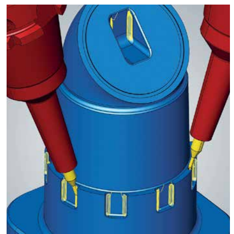
Bei der 3D- und 5-Achs-Bearbeitung sorgen neue Algorithmen zur Restmaterialerkennung für eine automatische und vollständige Erfassung aller Restmaterialbereiche. OPEN MIND
