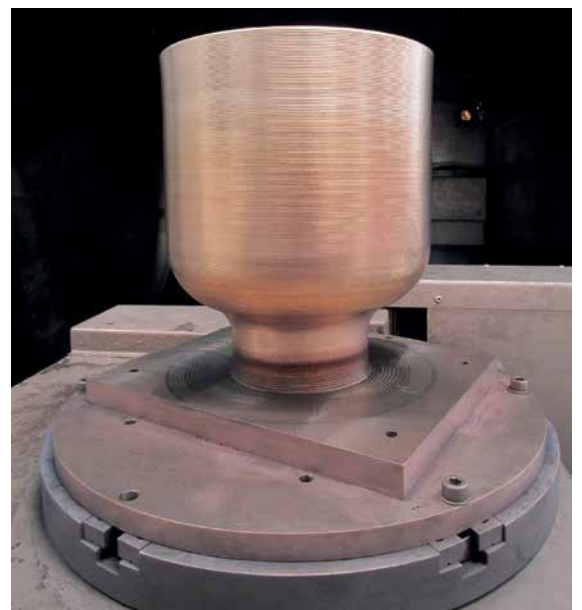
Aus Kupfer gefertigte Halbschale mit hoher Oberflächenqualität bei einer Auftragsrate von 2 kg/h (as-built). PRO-BEAM
